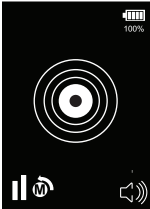
Abb. 28: Handmodus-Reset-Symbol blinkt synchron mit Resettastendruck
