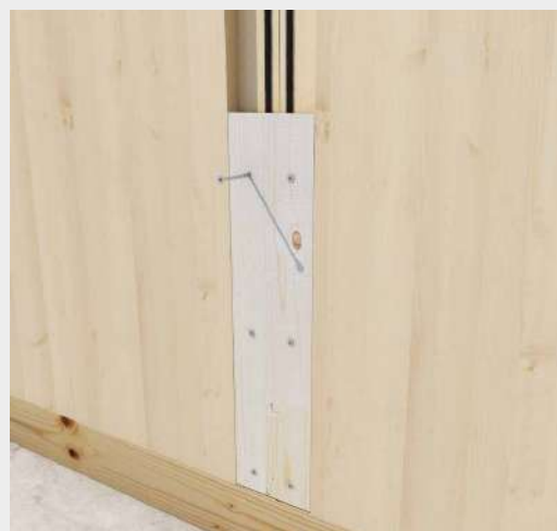
^ Fastsättning av väggar av CLT med skruvar HBS med diameter 6 mm.
